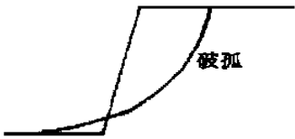
图 4 破弧示意图 Fig. 4 Sketch map of broken arc
